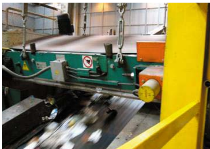
Foto 3 - Separatore elettromagnetico a nastro
