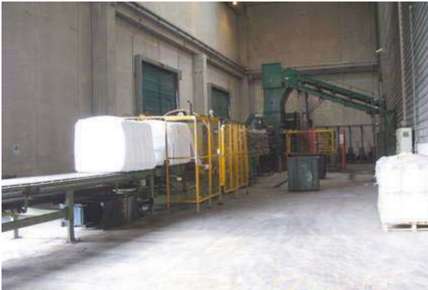
Foto 5 - Balle di CdR in fase di imballaggio e rivestimento con film plastico
