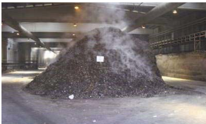
Foto 6 - Cumulo di frazione organica in fase di stabilizzazione
