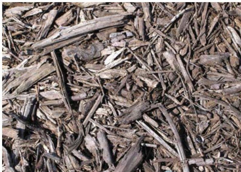
Foto 13 - Particolare del materiale legnoso che costituisce il biofiltro
