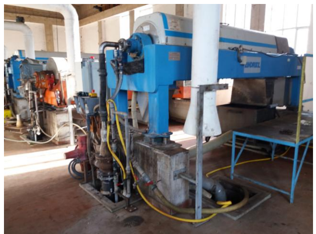
Centrifughe. Le tubazioni bianche sono l'aspirazione diretta al filtro
