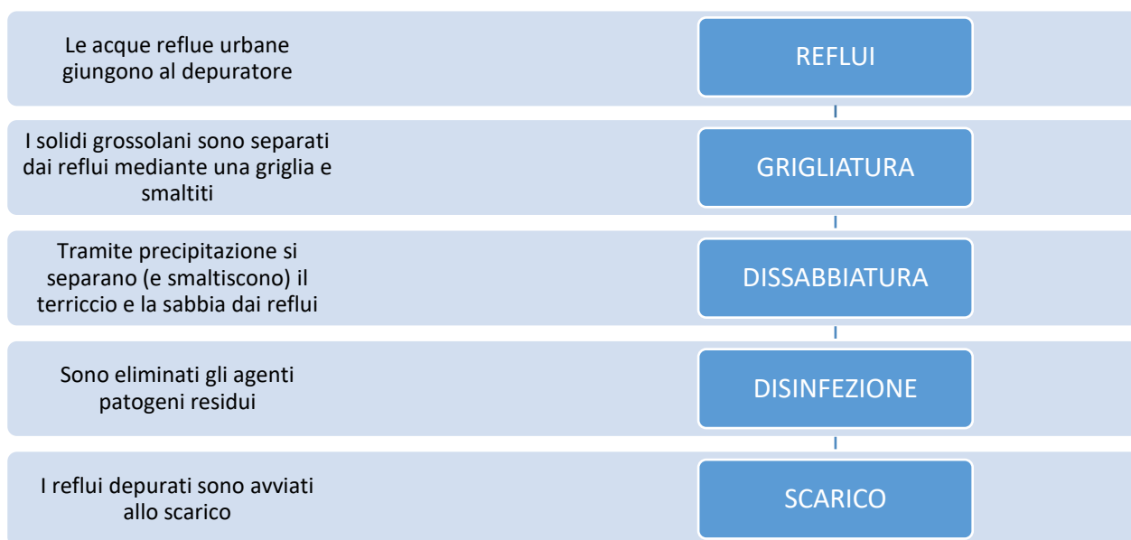
Figura 1. Schema di un impianto di pretrattamento
