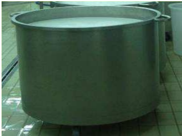
Foto B.1 - Tina, in acciaio inox, utilizzata nel processo di produzione della mozzarella Foto ARPAC/DT-UORUS 2012
