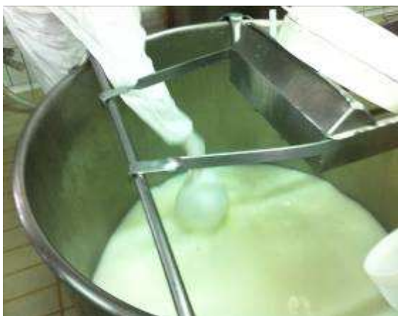
Foto C.3 – Tina di accumulo temporaneo delle acque di filatura. Foto ARPAC/DT-UORUS 2012
