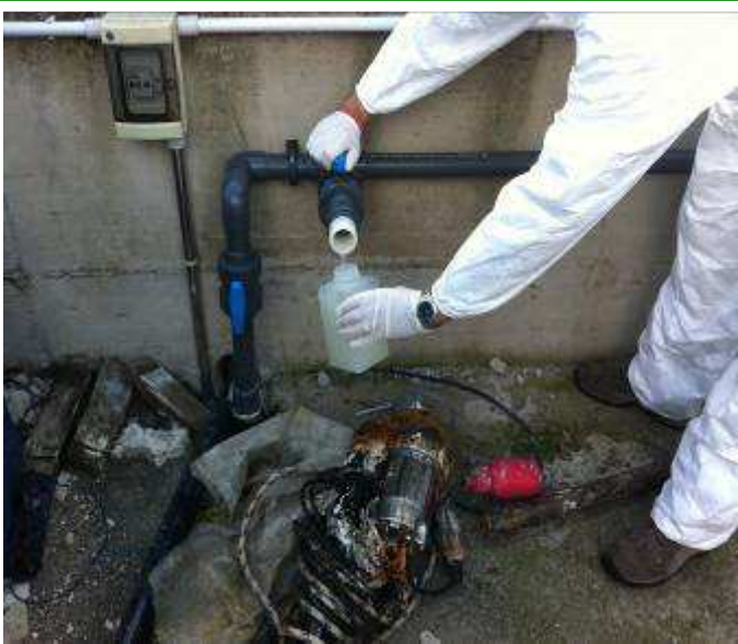
Foto C.4 – Prelievo dei reflui eseguito sulla condotta di mandata all’impianto di depurazione. Foto ARPAC/DT-UORUS 2012
