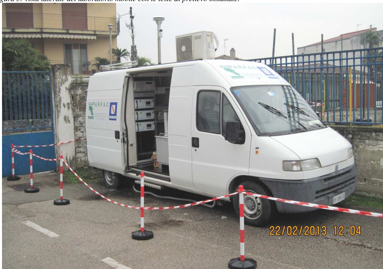
Figura 3: vista laterale del laboratorio mobile con le teste di prelievo installate.
