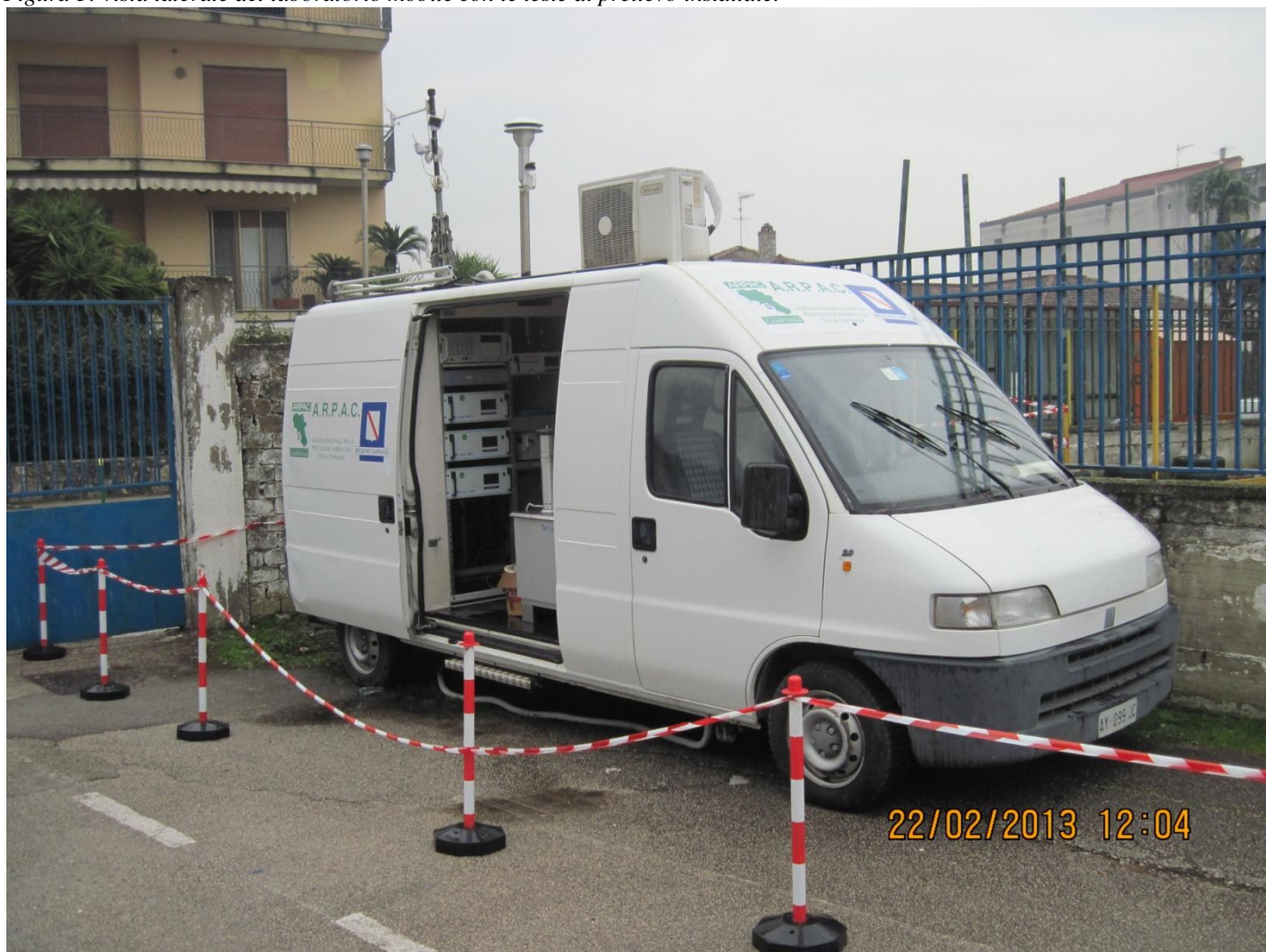
Figura 3: vista laterale del laboratorio mobile con le teste di prelievo installate.
